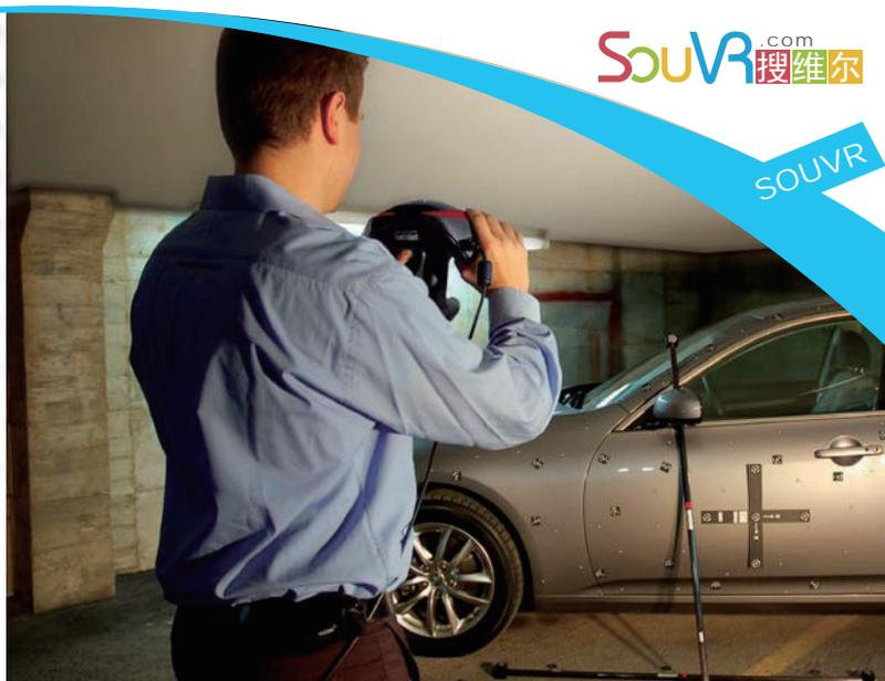
**自定位：**由于定位系统固定在部件上，因此周围环境的波动（如振动或风）不会影响数据采集的速度或精度。
