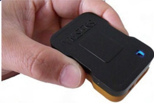
iVM-BT 是VMSENS公司提供的基于MEMS技术的低成本，高性能的无线惯性三维运动姿态追踪测量系统。
